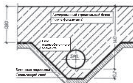
Утолщение в плите фундамента
