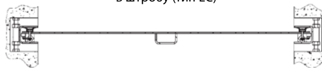
Установка бетонированием в штробу (тип ЕС)
