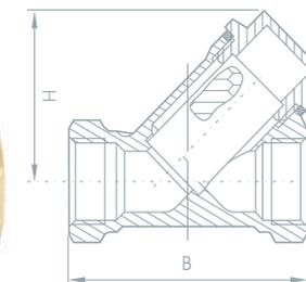
Материал корпусных деталей – латунь ЛС59-1 по ГОСТ 15527-2004. Материал сетки фильтра – нержавеющая сталь 12Х18Н10Т по ГОСТ 5632-72.
