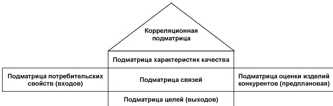
Рисунок 2 — Типовая структура матрицы СФК («дом качества»)
