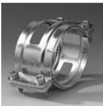
Усиливающий хомут Rekord Хомут защищает от воздействия продольных сил. Используется для всех соединений Rapid, для давления более 0,5 бар
