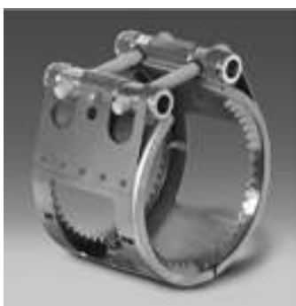
Усиливающий хомут CV Хомут защищает от воздействия продольных сил. Используется для всех соединений CV и CE, для давления более 0,5 бар
