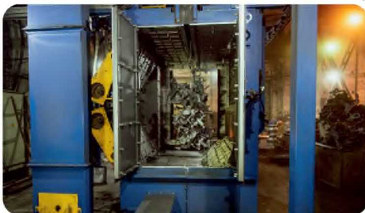
Очистка литья в дробемете проходного типа
